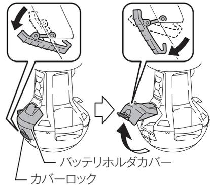
2. バッテリーを本製品の溝に合わせ、「カチッ」と音がするまでしっかり差し込みます。
