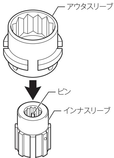
3. インナースリーブを取り付けたアウタースリーブを本機にはめます。インナースリーブを左右に回しながら確実にはめてください。
