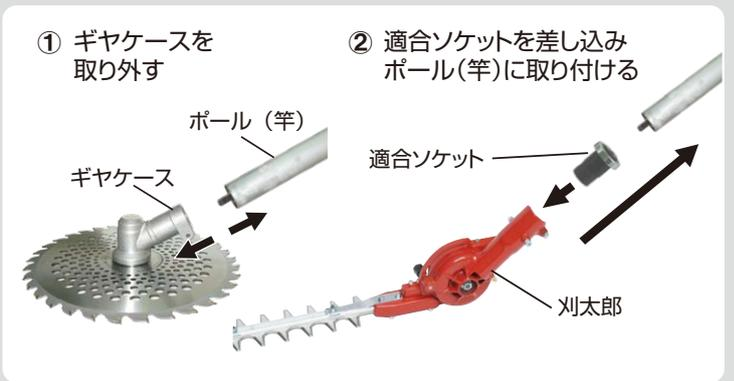
■取付方法 事前にドライブシャフト形状/ポール外径を確認してください(上図参照)
