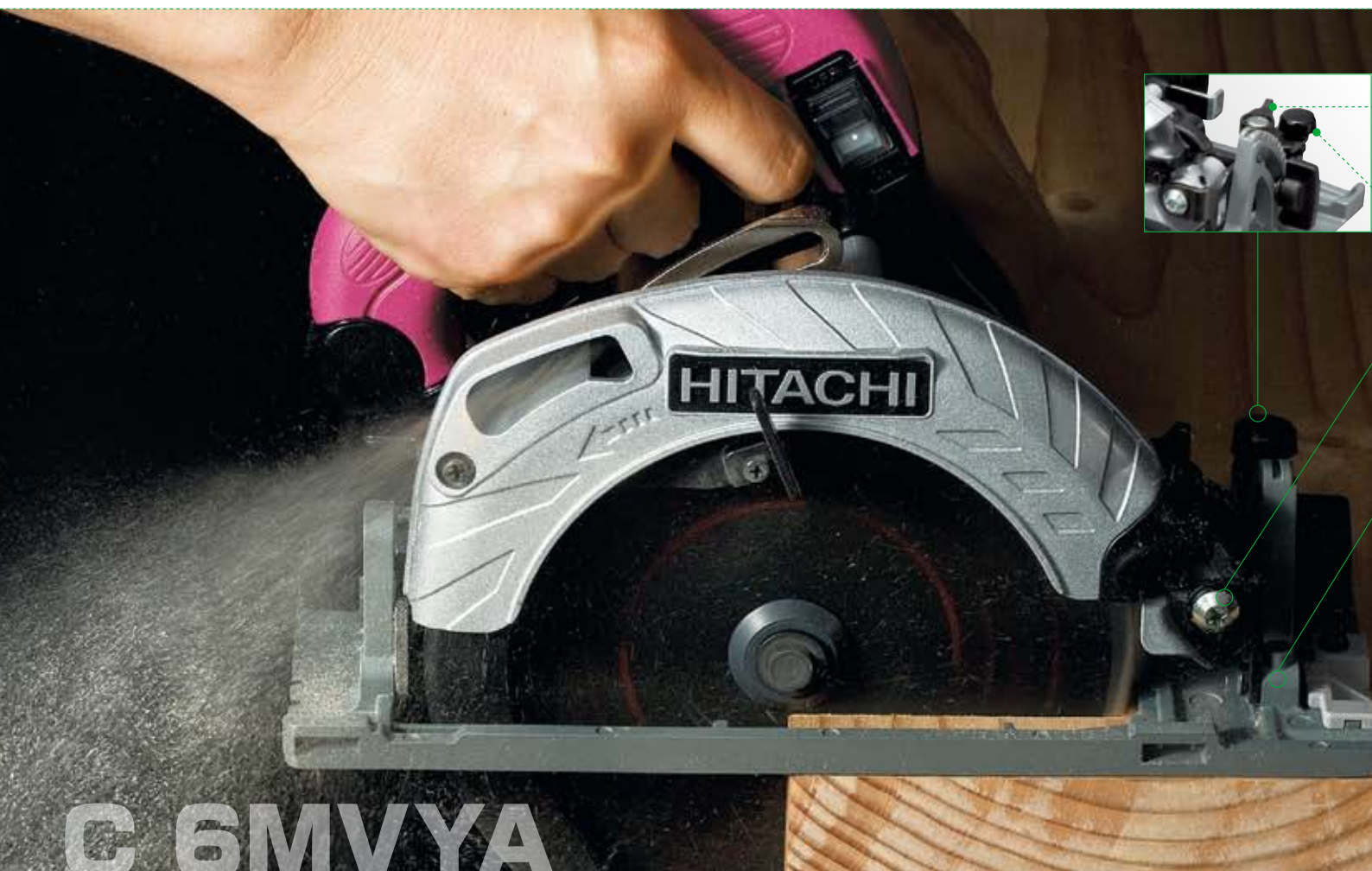
レバーと一緒にカムが回転し、リンクを固定させます。
