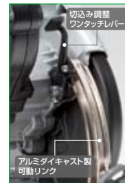
レバーと一緒にカムが回転し、リンクを固定させます。
